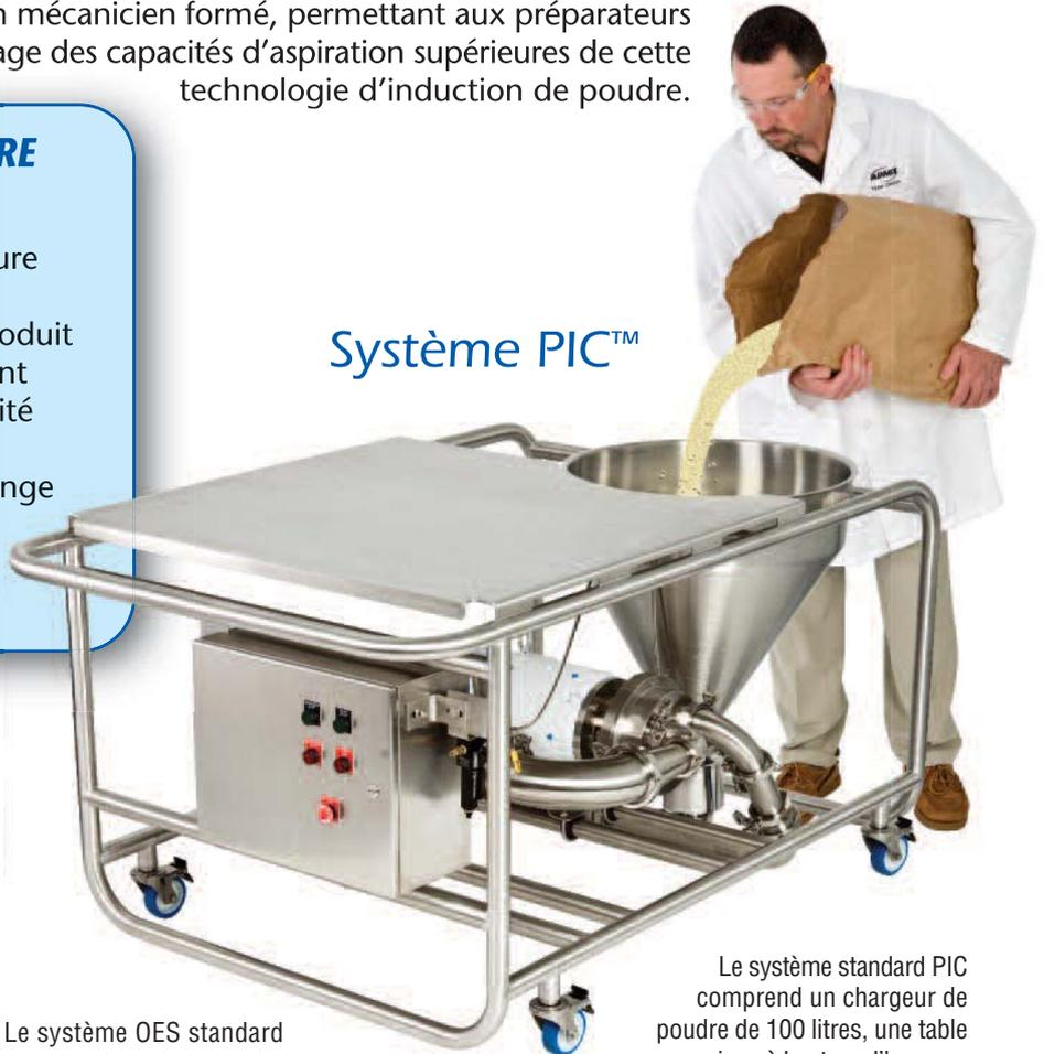
Le système standard PIC comprend un chargeur de poudre de 100 litres, une table ergonomique à hauteur d'homme, une pompe d'aspiration de poudre sanitaire, un clapet à poudre, un manomètre à vide, un clapet de régulation de vide, un boîtier de commande pour la pompe et la tuyauterie d'interconnexion
